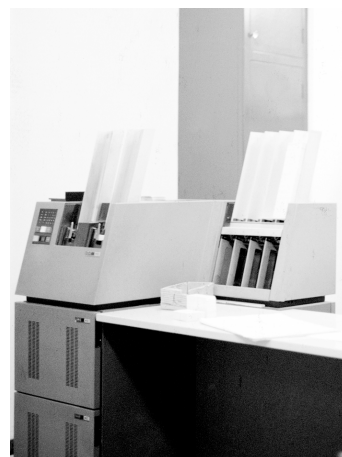
Figura 3 Las tarjetas y las cintas perforadas se utilizaban para programar los computadores y para recibir los resultados de sus cálculos mediante máquinas lectoras-perforadoras de tarjetas.
